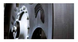
Outras vantagens do sistema de acionamento são os seus altos níveis de robustez e confiabilidade, bem como os seus requisitos mínimos de manutenção. Se ocorrer a queda de materiais indesejados na câmara de corte, o limitador de torque (embreagem de segurança) evita danos ao equipamento.
