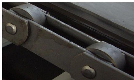
Opcionalmente, cadena con punto de rotura de hasta 140kN por cadena,
