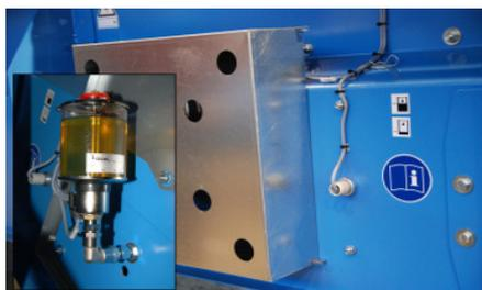
Lubricación automática de la cadena mediante engrasador por goteo con válvula magnética,
