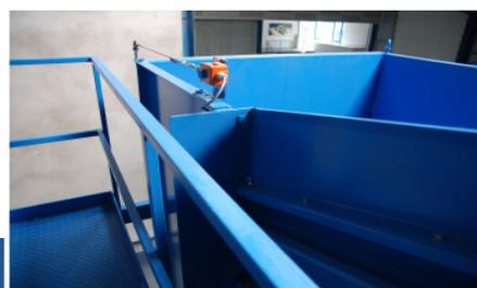
Sistema de parada de emergencia de cable en lo alto de la tolva de la cinta transportadora,
