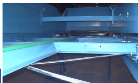
Soportes de deslizamiento adicionales en la sección del tramo horizontal y ascendente con el fin de absorber fuertes impactos,
